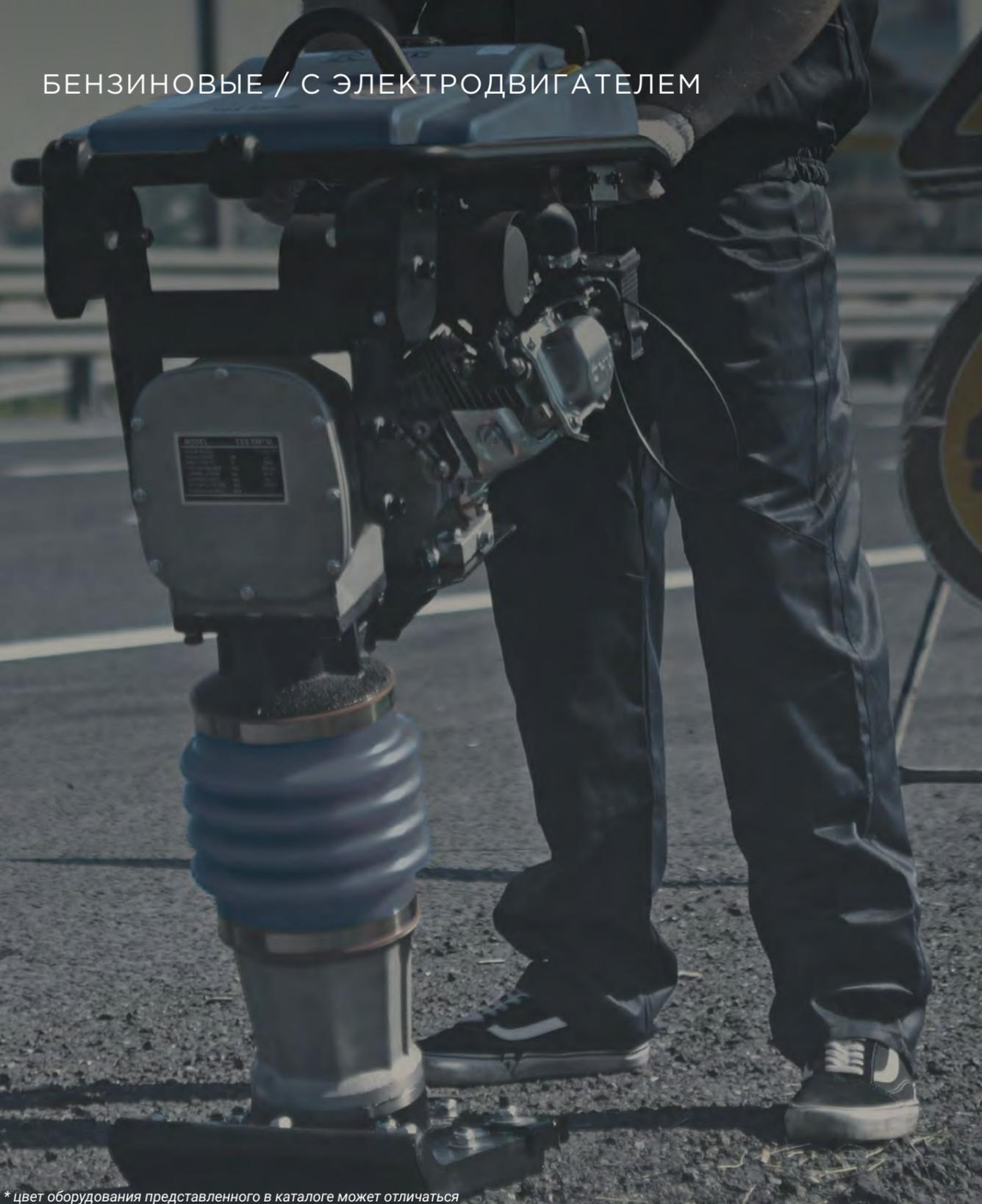
Вибротрамбовки предназначены для уплотнения различных видов сыпучих и связных покрытий на ограниченных площадях.
