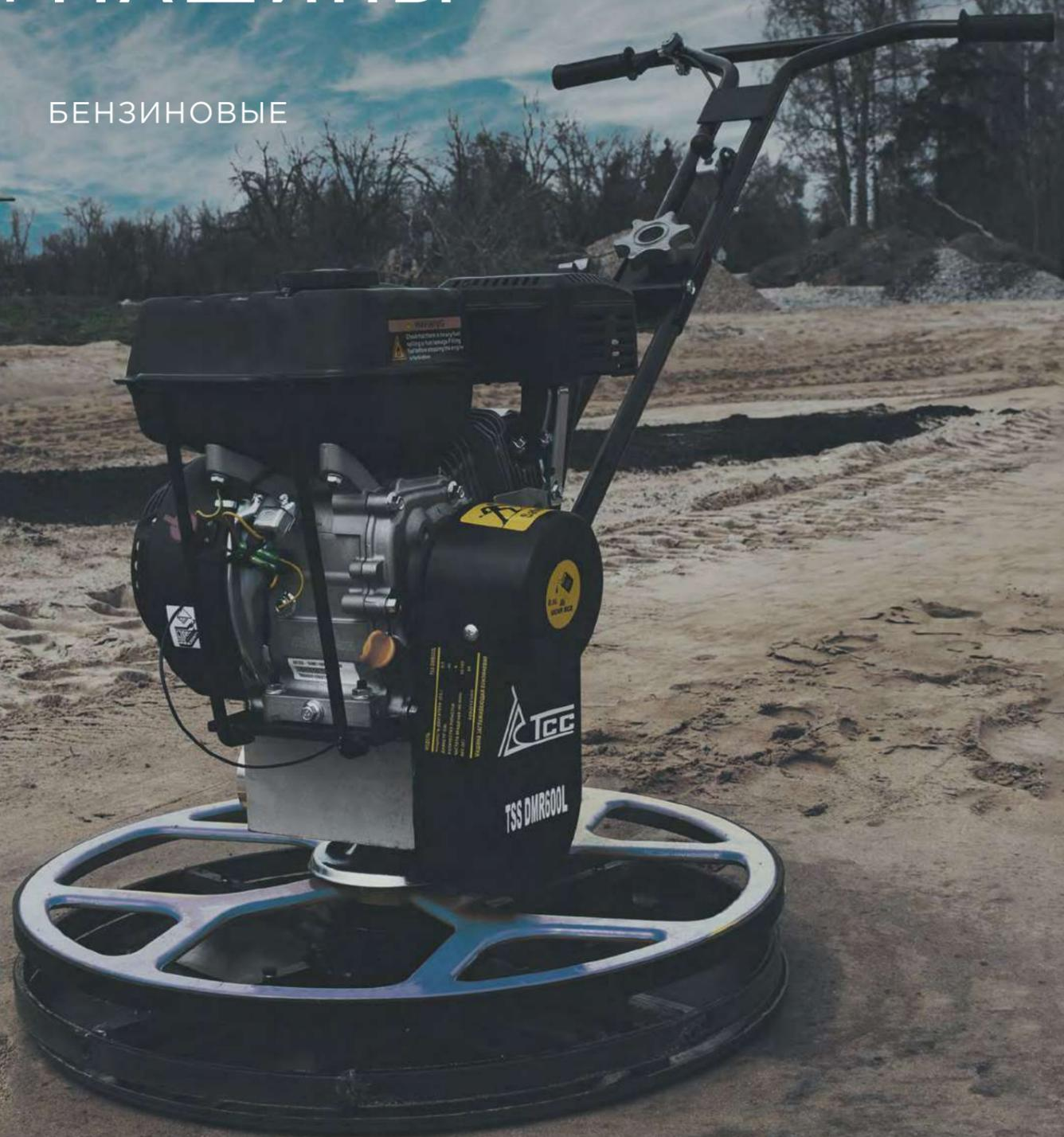
Применение затирочных машин для выравнивания бетонных покрытий позволяет быстро и качественно создать идеальную поверхность, готовую для финишной отделки. В модельном ряду ТСС вы найдете универсальные однороторные и профессиональные двухроторные модели. Бензиновые или электрические – выбор за вами в зависимости от того, где будет использоваться техника. Электрические заглаживающие машины позволяют проводить работы в закрытых или плохо вентилируемых помещениях.
