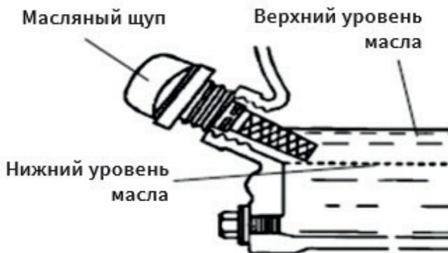
Рекомендованное к использованию полусинтетическое моторное масло ГК ТСС Портатив SAE 10W-40 API SG/CD
