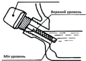
Снимите крышку маслозаливной горловины (щуп).
