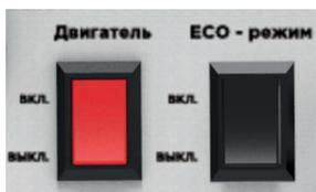
1. Поставить выключатель двигателя в положение "ВКЛ."
